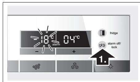
Temperaturindikatorn visar under 10 sekunder den varmaste temperatur som varit i frysutrymme. Därefter visas åter den inställda temperaturen.
