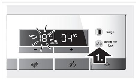
Pakastinosassa ollut korkein lämpötila tulee näkyviin lämpötilanäyttöön 10 sekunniksi. Sitten näkyviin tulee taas säädetty lämpötila.
