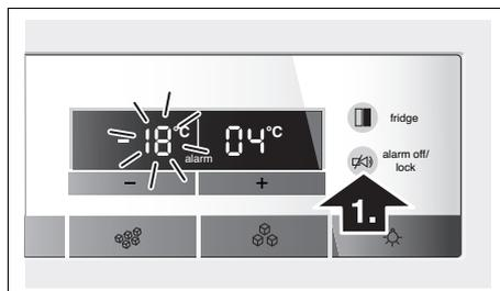
Temperaturvisningen viser i 10 sekunder den varmeste temperatur, der har været i fryseren. Herefter vises den indstillede temperatur igen.
