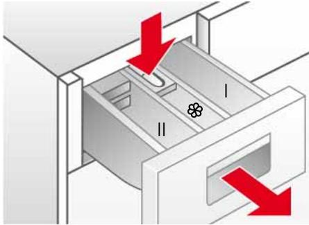
Die Waschmittelschublade ist in drei Kammern unterteilt
