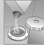
Max. 1,5 kg Speziialsalz (nie Reiniger!) einfüllen.
