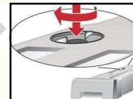
5. Inserire il contenitore dell'acqua di condensa fino all'arresto.
