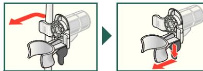
4. Installare le coperture. Fissarle bene mediante pressione sul gancio a scatto. Installare il supporto per tubo flessibile.
