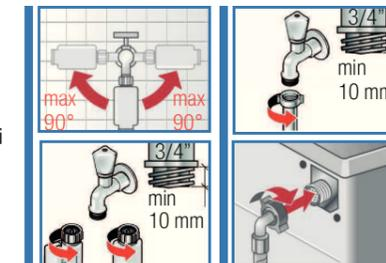
2. Aprire con attenzione il rubinetto dell'acqua e contemporaneamente controllare la tenuta dei punti di collegamento.
