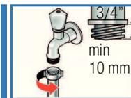
2. Aprire con attenzione il rubinetto dell'acqua e contemporaneamente controllare la tenuta dei punti di collegamento.
