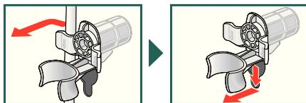
4. Installare le coperture. Fissarle bene mediante pressione sul gancio a scatto. Installare il supporto per tubo flessibile.
