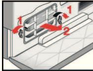
5. Luftkühler entfernen.
