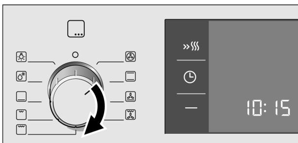
2. S temperaturnim regulatorjem izberite temperaturo ali pečenje na žaru.
