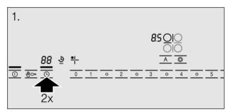
**2.** Unutar slijedećih 10 sekunda namjestite željeno trajanje na području za namještanje.
