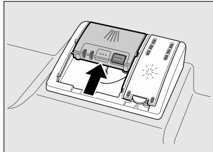
Komora pro mycí prostředek se v závislosti na programu automaticky otevře v optimální časový okamžik. Práškový nebo tekutý mycí prostředek se ve spotřebiči rozdělí a rozpustí, tableta spadne do záhytné misky na tablety a dávkované se zde rozpustí.
