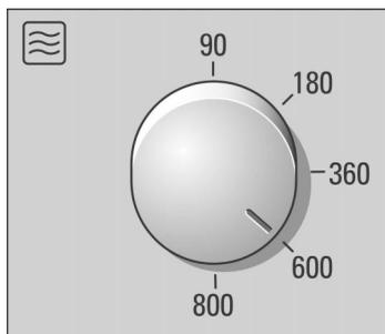
1. Poner el selector de potencia en la potencia del microondas deseada.
