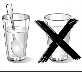
Sıvılar ısınma esnasında buharlaşma nedeniyle azalabilir. Yani tipik buharlaşma kabarcıkları oluşmadan kaynama noktasına ulaşılacaktır. Kabın sadece biraz sarsılması durumunda bile sıcak sıvı aniden taşabilir veya sıçrayabilir. Yanma tehlikesi!
