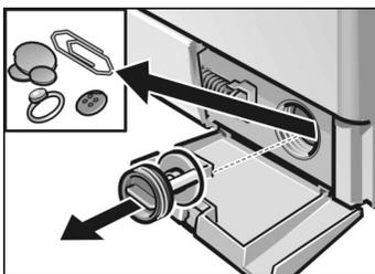
Rengøring er nødvendig, når pumpen er blokeret af knapper, klemmer eller lignende, og vandet ikke kan pumpes ud eller efter vask af tøj, der fnugger kraftigt.
