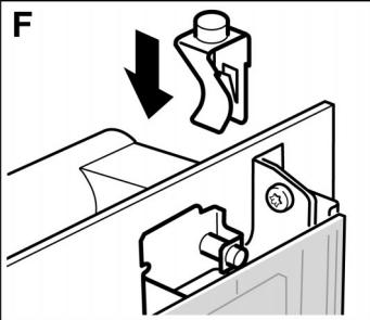
8. Die Klammer mit dem Magneten wieder aufstecken. (Bild F)
