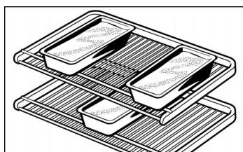
Wenn Sie mit 3 Kastenformen gleichzeitig backen, stellen Sie diese wie im Bild abgebildet auf die Roste.
