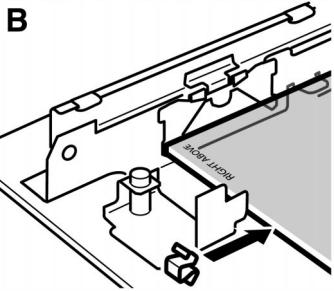
3. Die kleinen Klammer wieder an der unteren Glasscheibe aufstecken. (Bild B)
