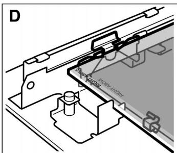
5. Die Haltefedern rechts und links nach außen drücken, so dass die Scheibe aufliegt. (Bild D)
