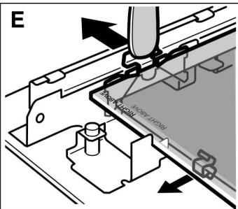
6. Die Haltefedern rechts und links vorne nach einander nach außen drücken. Sollten sich die Klammer schwer zur Seite drücken lassen, nehmen Sie einen Löffel zu Hilfe. (Bild E)
