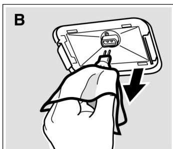
Wenn die Backofenlampe ausgefallen ist, muss sie ausgewechselt werden. Temperaturbeständige Halogenlampen, 10 Watt, erhalten Sie beim Kundendienst oder im Fachhandel. Halten Sie die Halogenlampe mit einem trockenen Tuch. Dadurch wird die Lebensdauer der Lampe verlängert. Verwenden Sie nur diese Lampen.
