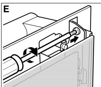
7. Die beiden Schrauben links und rechts wieder einschrauben. (Bild E)
