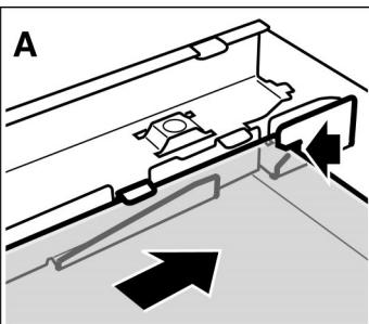
1. Die untere Glasscheibe schräg nach hinten einschieben. (Bild A)
