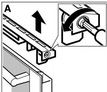
2. Die Abdeckung oben am Backwagen abschrauben. Dazu die Schrauben links und rechts aufdrehen. (Bild A)
