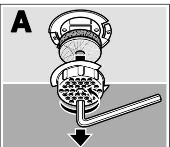
1. Mit einem Sechskantschlüssel (6 mm) den Filtertopf nach links drehen und abnehmen. Bild A.
