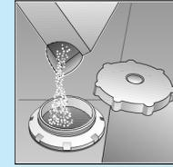
Max. 1,5 kg **Speziialsalz** (nie Reiniger!) einfüllen.
