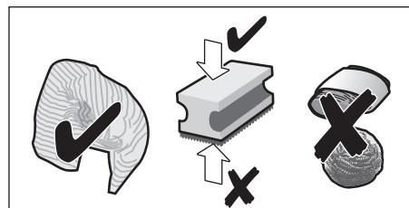
■ Îndepărtați întotdeauna imediat rezidurile de calcar, cafea, lapte, detergent și detartrant. Aceste reziduuri pot conduce la coroziune.
