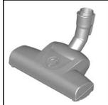
Borstelen en zuigen van tapijten en tapijtvloeren met korte pool en van alle bekleding in één keer. Met name geschikt voor het opzuigen van dierharen. De rolborstel wordt aangedreven door de zuigstroom van de stofzuiger. Geen elektrische aansluiting vereist.
