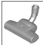
Jednoczesne szczotkowanie i odkurzanie dywanów i wykładzin dywanowych z krótkim włosiem, względnie wszystkich wykładzin. Szczególnie nadaje się do usuwania sierści zwierząt. Napęd walca szczotkowego odbywa się za pomocą strumienia powietrza zasysanego przez odkurzacz. Nie jest wymagane podłączenie do sieci elektrycznej.
