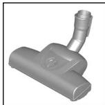
Rövid szálú szőnyegek és szőnyegpadlók, illetve mindenféle padlóburkolat kefék tisztítása és porszívózása egy munkamenetben. Különösen alkalmas állatszór felszívására. A kefedob meghajtását a porszívó szívási légárama biztosítja. Ehhez elektromos áramot nem igényel.
