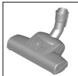
Per spazzolare e pulire in una sola operazione moquette e tappeti a pelo corto e per tutti i tipi di rivestimento. Ideale per l'aspirazione dei peli di animali. L'azionamento del rullo della spazzola avviene tramite la corrente di aspirazione dell'aspirapolvere. Non è necessario stabilire un collegamento elettrico.
