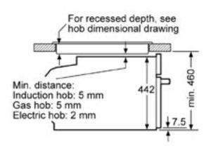
$Measurements\ in\ mm$
