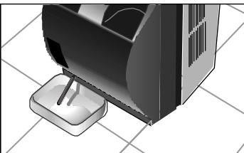
Vor dem Transport ist das Wasser aus dem Kondensatbehälter abzulassen, bevor das Gerät geneigt oder gekippt wird. Das Ablassen erfolgt über den Wasserablassschlauch, der an der Ablauföffnung an der Geräteunterseite angeschlossen wird.
