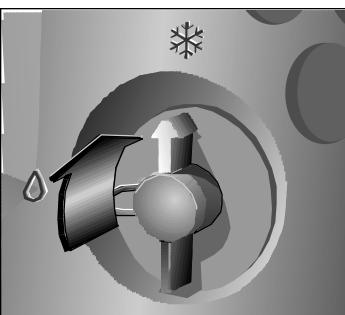
Pendant la climatisation, l'eau condensée résultante s'évapore automatiquement et est évacuée vers l'extérieur avec l'air expulsé, au travers du tuyau d'expansion d'air chaud.
