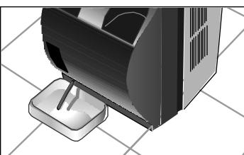
L'apparecchio è munito di ruote onde facilitarne lo spostamento. Nel caso in cui sia necessario inclinare l'apparecchio per spostarlo, bisogna svuotare l'acqua che è nel serbatoio interno, con l'aiuto del tubo di scolo abbinato alla chiave della parte inferiore dell'apparecchio.
