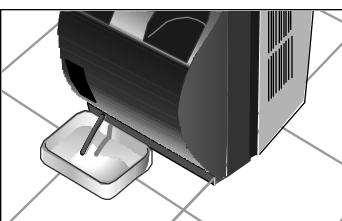
O aparelho dispõe de rodas para facilitar a sua mudança de sítio. No caso de ser necessário inclinar o aparelho para o mudar de lugar, é necessário esvaziar a água que se encontra no depósito interno com a ajuda do tubo de evacuação de água acoplado à chave da parte inferior do aparelho.
