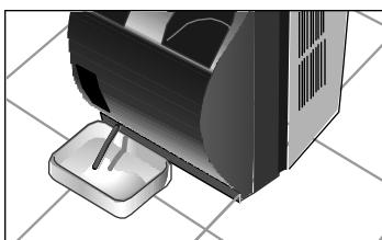
El aparato dispone de ruedas para facilitar su traslado. En caso de que sea necesario inclinar el aparato para su traslado, hay que vaciar el agua que se encuentra en el depósito interno con la ayuda del tubo de desagüe acoplado a la llave de la parte inferior del aparato.
