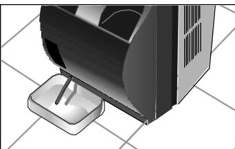
L'appareil dispose de roues pour rendre son déplacement plus facile. S'il était nécessaire d'incliner l'appareil pour son déplacement, il faudrait vider l'eau se trouvant dans le réservoir interne à l'aide du tuyau d'évacuation accouplé à l'embout de la partie inférieure de l'appareil.
